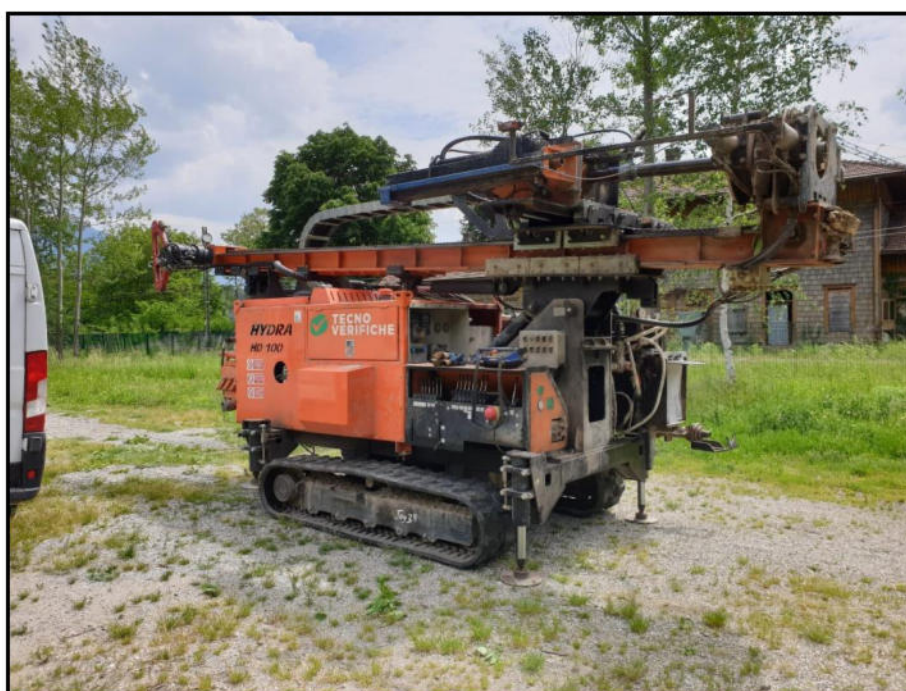
Fig. 2: Sonda perforatrice Hydra Joy3
